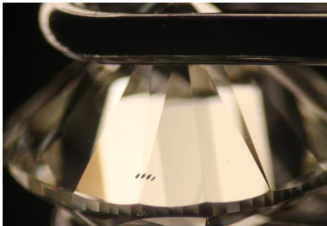
รูปที่ 2 แสดงลักษณะทางแสงภายใต้แผ่นกรองแสงโพลาไรซ์แบบตั้งฉาก ในเพชรสังเคราะห์ HPHT ที่ไม่ปรากฏร่องรอยของแรงเค้น
