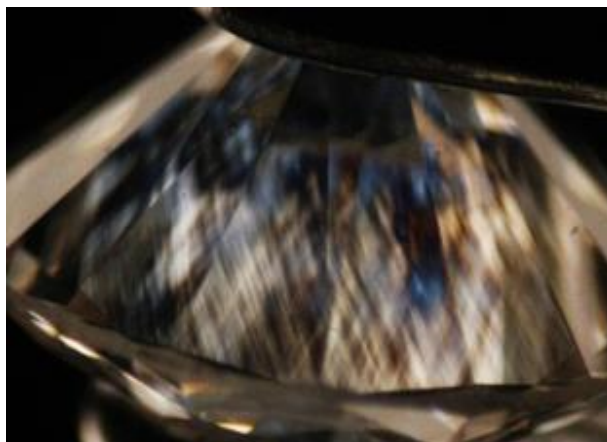
รูปที่ 1 แสดงลักษณะทางแสงภายใต้แผ่นกรองแสงโพลาไรซ์ตั้งฉาก เป็นเส้นถี่ๆ สีดำเรียงตัวตัดกันในเพชรสังเคราะห์ CVD
