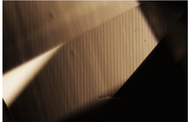
รูปที่ 3 แสดงลักษณะมลทินสีดำ (ซ้าย) และมลทินเส้นร่องรอยการเจริญเติบโต (ขวา) ในเพชรสังเคราะห์ CVD
